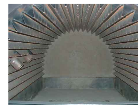
Camera di combustione con alette di scambio termico
