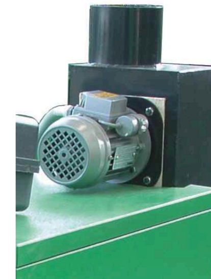
Camera fumi con tiraggio agevolato per mezzo di gruppo elettroventilatore
