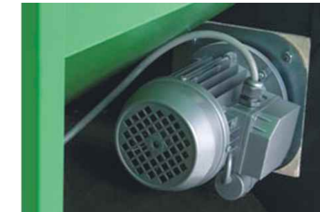
Elettroventilatore aspirazione fumi
